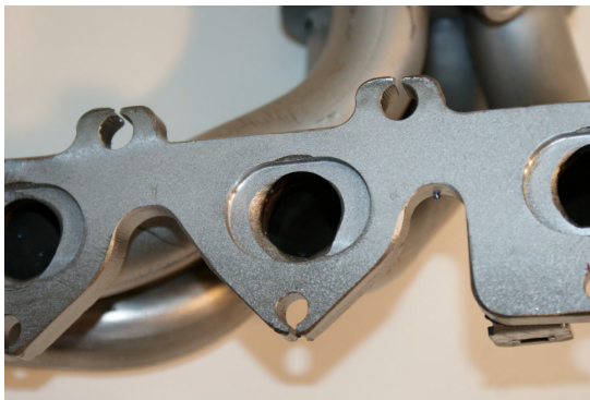
Bild 5: Die Flanschöffnungen sind zu klein
