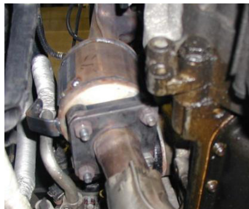
Bild 2: Platzprobleme im Motorraum Der Krümmer-Katalysator ist nicht einbaubar, weil ein zu großer Monolith verwendet wurde.
