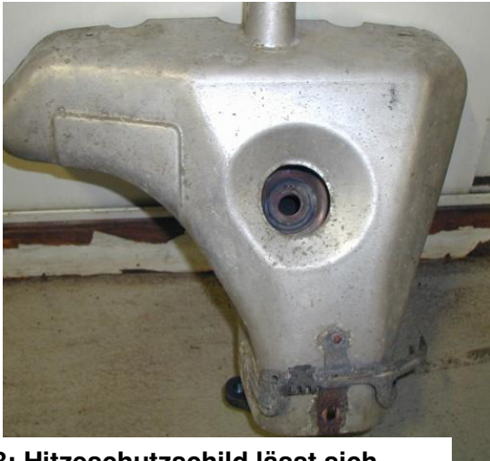
Bild 3: Hitzeschutzschild lässt sich nicht montieren
