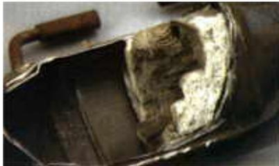
Fehler an der Gemischaufbereitung führen zu Kraftstoffanteilen im Abgas und damit zu einer Überhitzung mit Anschmelzen des Monolithen.
