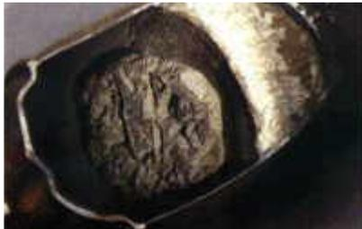
Defekte an der Gemischaufbereitung oder ein Ausfall an der Zündanlage führen zu einer gewaltigen Hitzeentwicklung im Katalysator. Der Monolith schmilzt und kann aufgrund der thermischen Spannungen radial brechen.
