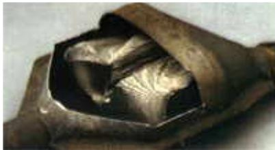
Zerstörungen des Monolithen aufgrund mechanischer Beschädigung (Aufsetzen). Bruchstücke können die Abgasanlage verstopfen, es kommt zu einer starken Geräuschentwicklung.
