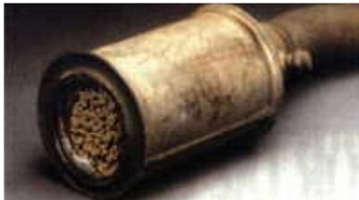
Tröpfchen von Kraftstoff oder Motoröl können derartige Anschmelzungen im Katalysatoreintritt bewirken.
